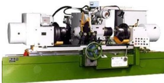
Рисунок 2 -Круглошлифовальный станок ЗД4230
