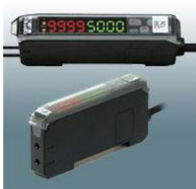
Рисунок 1 – Оптоволоконный усилитель
